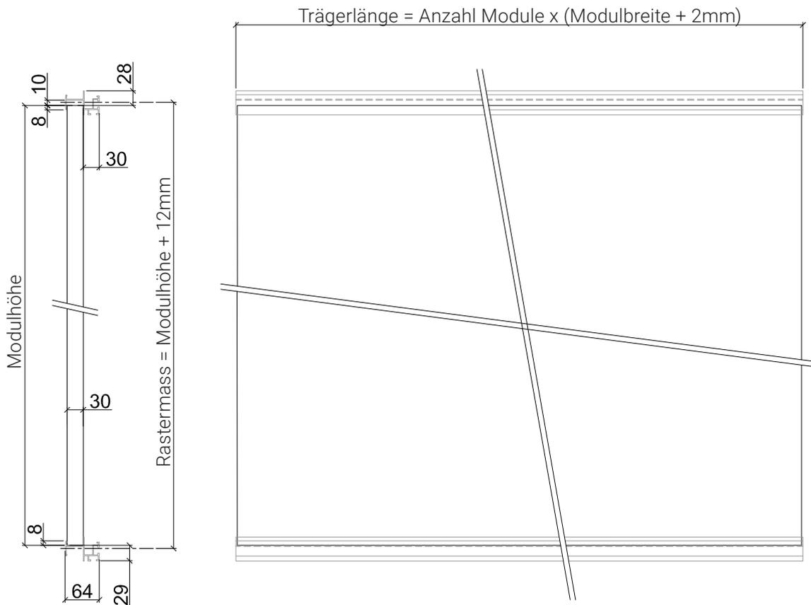
Rechnungsbeispiel Trägerlänge:  $3 \times (1773\text{mm} + 2\text{mm}) = 5325\text{mm}$
